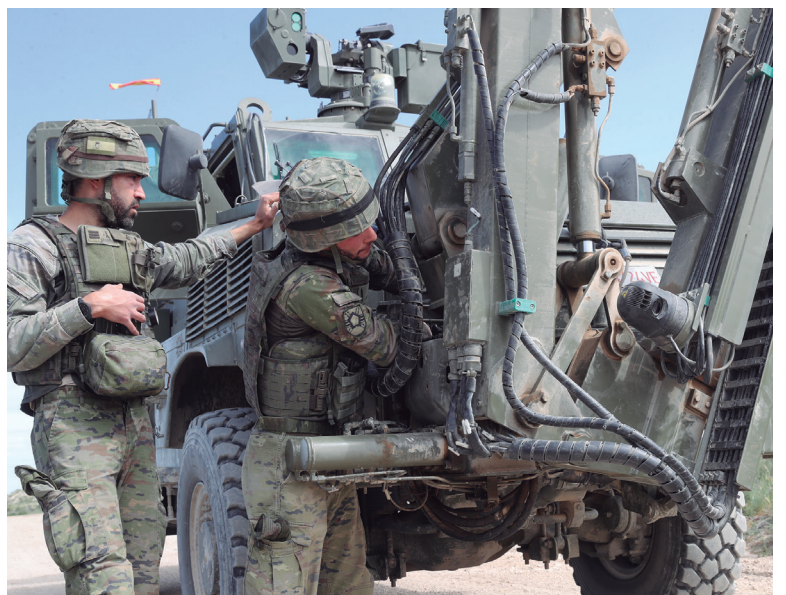
El RG31 del Regimiento de Ingenieros nº 1 cuenta con un brazo telescópico —arriba— que es operado de manera remota desde el interior o el exterior del vehículo para recoger y detonar a distancia cualquier tipo de mina o artefacto explosivo improvisado.
