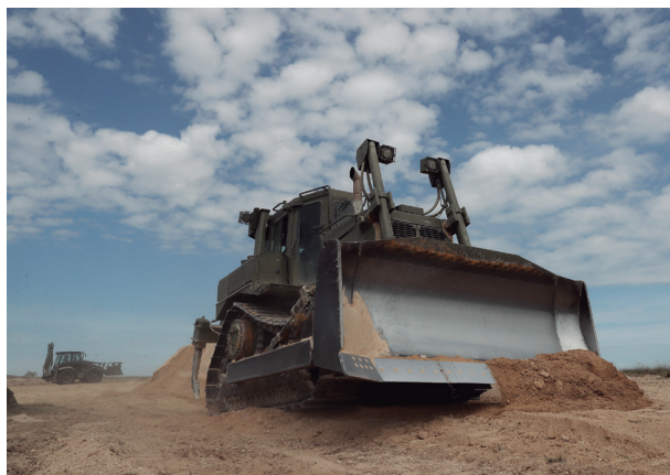
Una empujadora del pelotón de excavación trabaja en la construcción de un foso contra carro.
