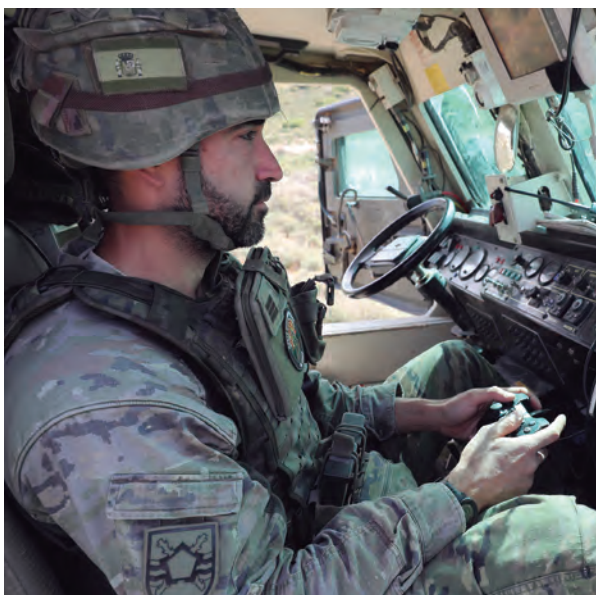
El RG31 del Regimiento de Ingenieros nº 1 cuenta con un brazo telescópico —arriba— que es operado de manera remota desde el interior o el exterior del vehículo para recoger y detonar a distancia cualquier tipo de mina o artefacto explosivo improvisado.
