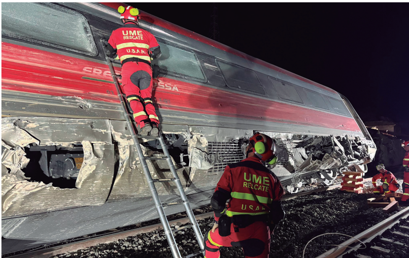
Miembros del equipo USAR del BIEM II realizan trabajos de apuntalamiento de los vagones que descarrilaron del tren Iryo.
