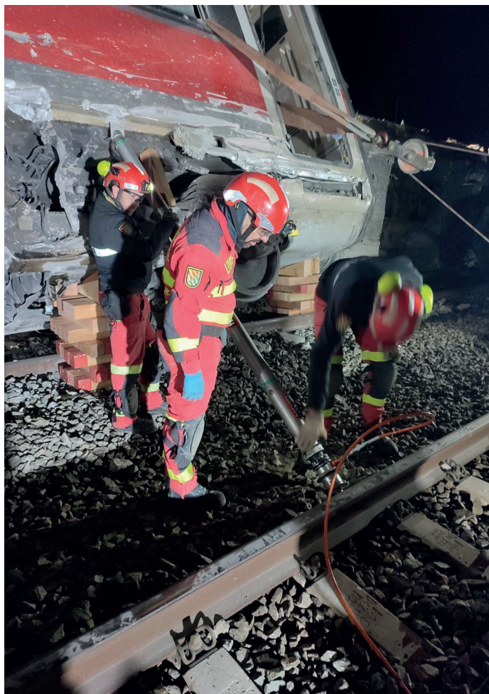
La labor de la UME en Adamuz se ha centrado en la estabilización de los vagones siniestrados para facilitar su retirada y proporcionar seguridad a los trabajos del resto de servicios de emergencias.
