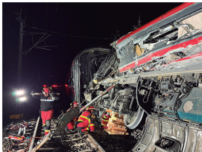
La labor de la UME en Adamuz se ha centrado en la estabilización de los vagones siniestrados para facilitar su retirada y proporcionar seguridad a los trabajos del resto de servicios de emergencias.
