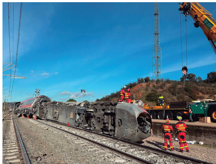
Miembros del equipo USAR del BIEM II realizan trabajos de apuntalamiento de los vagones que descarrilaron del tren Iryo.
