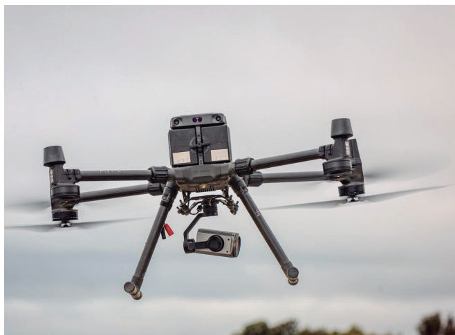
Un Mini DJI Matrice 300 del Regimiento de Artillería Antiaérea nº 71 configurado como UAV de vigilancia y reconocimiento.
