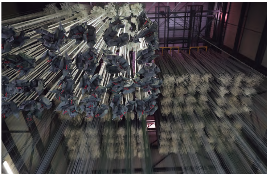
Hasta 240 paracaídas, agrupados por modelos, se secan y airean en una torre de 15 metros de altura, donde permanecen suspendidos durante al menos doce horas en penumbra.
