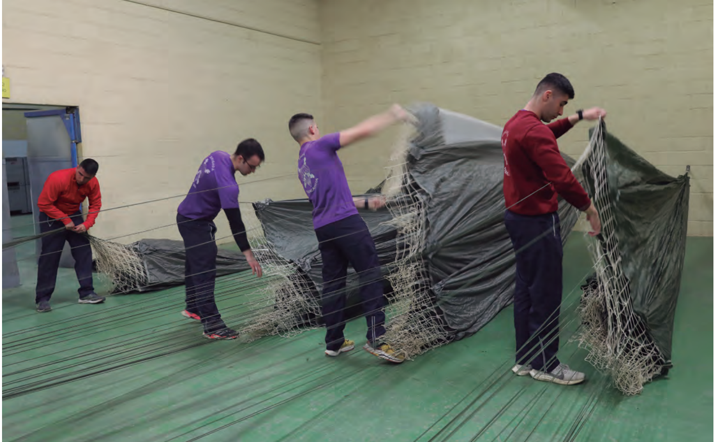
El primer eslabón del ciclo de mantenimiento de un paracaídas es la sala de desenredo. Tras desenmarañar los cordones y los mandos, se procede a extender y revisar los paños de la campana para detectar posibles roturas o defectos en la tela.
