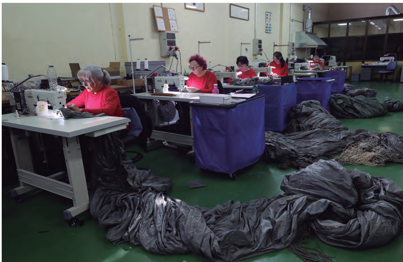
En el taller de reparación de material de paracaidismo trabajan ocho técnicos superiores en Patronaje y Moda, dos hombres y seis mujeres, especializados en el arreglo de las campanas, además del diseño y fabricación de arneses auxiliares, bandas, mochilas o fundas de armamento, entre otros elementos.
