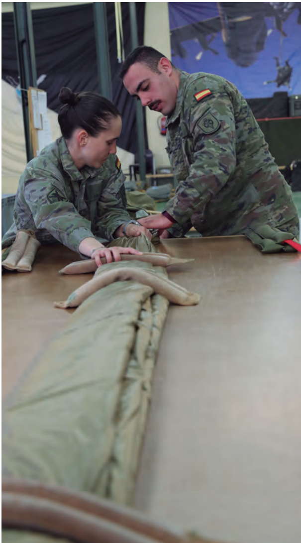
Los especialistas extienden los paracaídas principales de los TP-2Z y EPC-B conformando el «puro» para introducir la campana en la bolsa de despliegue, alinear sobre esta los cordones y, ya cerrada, comprobar el atalaje que le une al saltador.
