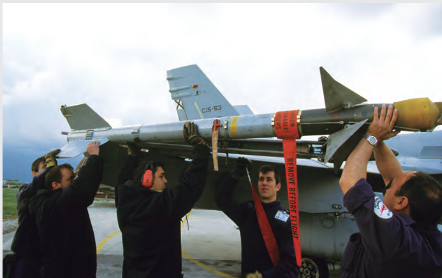
Varios miembros del Ejército del Aire montan un misil Sidewinder en un EF-18. Los aviones de combate iban armados con estos misiles para su autoprotección.
