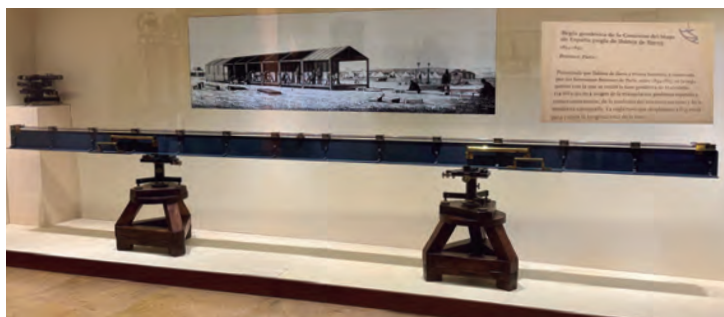
Regla geodésica de la Comisión del Mapa de España, proyectada por el científico español y que es conocida como «aparato Ibáñez».
