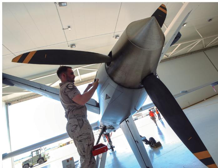
El MQ-9A es revisado antes del vuelo, tanto cámaras como motor turboprop. Debajo, un piloto observa su despegue. Para levantar el vuelo, el *Predator* necesita al menos un kilómetro de pista; cuanto más cargado vaya, mayor distancia precisará para el despegue.
