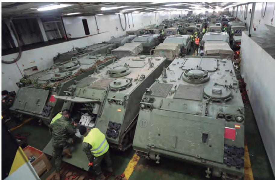
Detalle de la cubierta principal a plena carga con Tractores Oruga Acorazados (TOA) —en primer plano—, seguidos de remolques, *Pizarros* y *Leopard*, en el centro.
