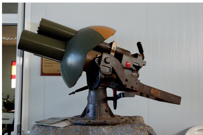
El obús S de 75 mm. dotó los seis tanques Schneider CA-1 llegados a España, de los que no ha sobrevivido ninguno.
