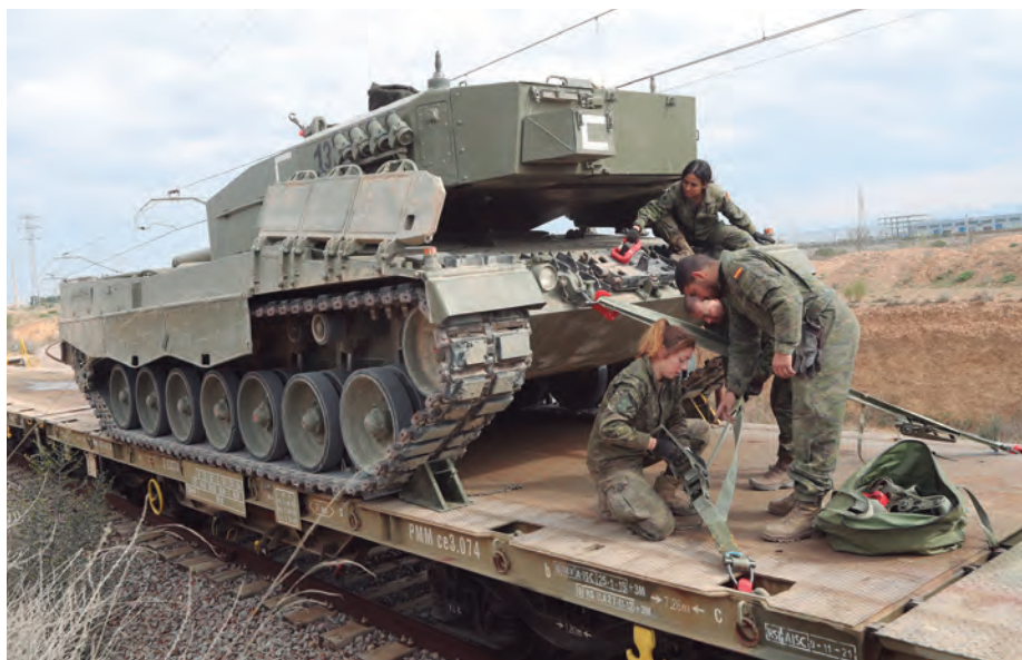
Los vehículos pesados que, como los carros de combate, superan las 54 toneladas, son amarrados con cintas capaces de soportar hasta 100 kilonewtons de fuerza.
