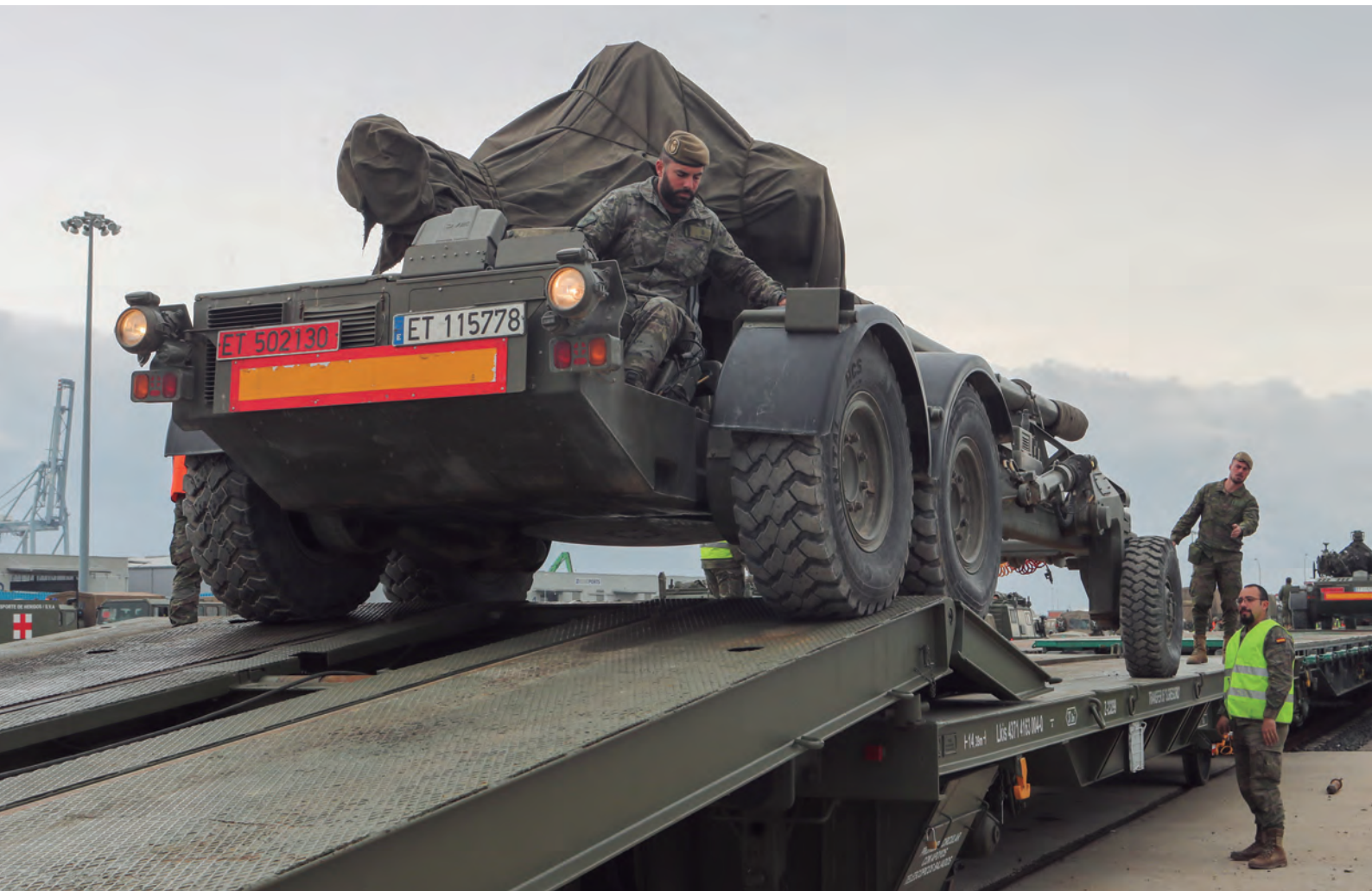
La compañía utiliza muelles TRANSFER para cargar y descargar los vehículos, entre ellos, obuses —arriba— y carros de combate, que son anclados a las plataformas por los miembros de la unidad.
