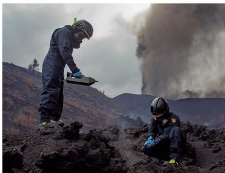
Equipos del GIETMA realizan mediciones de los gases emanados en el frente de la colada.
