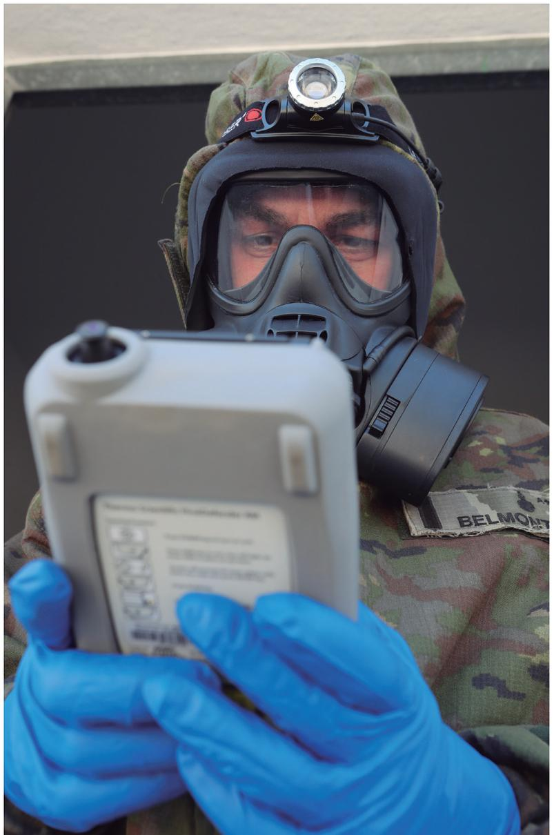
En los talleres de la unidad se inspeccionan, entre otros, los Equipos de Respiración Autónoma —arriba— y de impulsión de agua *Atila 20* —izquierda— y se calibran los detectores NBQ, como los de tecnología láser —derecha— para la identificación exacta de los agentes tóxicos, evitando los falsos positivos.
