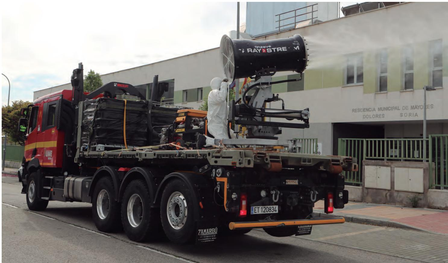
Labores de desinfección exterior con un cañón nebulizador instalado sobre un camión de la UME.
