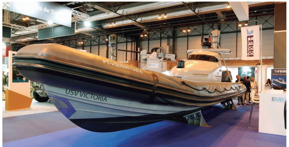
La plataforma naval por control remoto *USV Victoria* de la compañía Ferry configurada con la torre de control remoto *Sentinel 12.7 mm* y la cámara *OTEOS*, ambas de Escribano.
