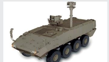
El demostrador 4 validará el Vehículo de Exploración de Caballería en configuración de Puesto de Mando de Sección. Su distribución interior permitirá alojar al jefe de vehículo, tirador, conductor y un equipo de cuatro exploradores. Estará armado con un cañón *Oto Melara Hitfist* de 30 mm sobre una torre tripulada protegida con blindaje adicional *add-on*.
