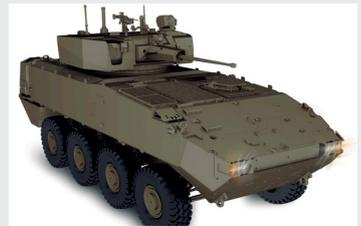
El D2 combinará la configuración de Puesto de Mando de Compañía con la de defensa contra carros de combate y medios acorazados. Además del jefe del vehículo, tirador y conductor, podrá acoger a tres combatientes. Estará equipado con una torre de accionamiento remoto *Rafael SAMSON MK-II* con cañón de 30 mm. y un lanzador doble de misiles contracarro *Spike*.
