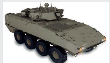
El D3 aúna la configuración de Puesto de Mando de Batallón con la de Observador Avanzado. La tripulación se completa con dos observadores avanzados. Incorpora la estación de armas remota polivalente *Guardian 2.0* del fabricante español *Escribano Mechanical & Engineering*, una ametralladora pesada de 12,7 mm. y los equipos específicos de observación avanzada.
