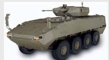
En el D5 se evaluará la protección balística *add-on*, contra minas e IED, el kit de protección contra lanzagranadas *RPG* y el equipamiento de combate de zapadores. En la carcaza de proa contará con un anclaje universal que intercambiará una pala empujadora para el movimiento de tierras, rodillo y arado contra minas. Estará armado con una estación remota polivalente *Mini Samson* de Rafael con ametralladora pesada de 12,7 mm.
