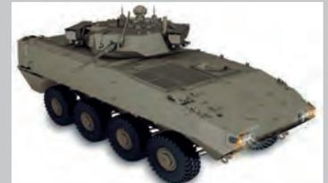
El D3 aúna la configuración de Puesto de Mando de Batallón con la de Observador Avanzado. La tripulación se completa con dos observadores avanzados. Incorpora la estación de armas remota polivalente *Guardian 2.0* del fabricante español Escribano Mechanical & Engineering, una ametralladora pesada de 12,7 mm. y los equipos específicos de observación avanzada.
