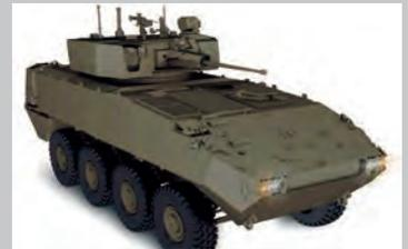
El D2 combinará la configuración de Puesto de Mando de Compañía con la de defensa contra carros de combate y medios acorazados. Además del jefe del vehículo, tirador y conductor, podrá acoger a tres combatientes. Estará equipado con una torre de accionamiento remoto *Rafael SAMSON MK-II* con cañón de 30 mm. y un lanzador doble de misiles contracarro *Spike*.
