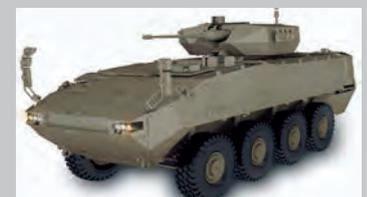
En el D5 se evaluará la protección balística *add-on*, contra minas e IED, el kit de protección contra lanzagranadas *RPG* y el equipamiento de combate de zapadores. En la barcaza de proa contará con un anclaje universal que intercambiará una pala empujadora para el movimiento de tierras, rodillo y arado contra minas. Estará armado con una estación remota polivalente *Mini Samson* de Rafael con ametralladora pesada de 12,7 mm.
