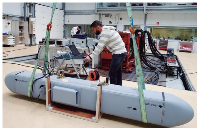
Ensayos de vibración sobre un pod de contramedidas electrónicas para aviones del Ejército del Aire.
