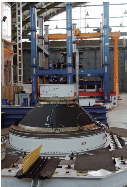
Adaptador de carga útil en el Centro de Ensayos del programa Ariane.
