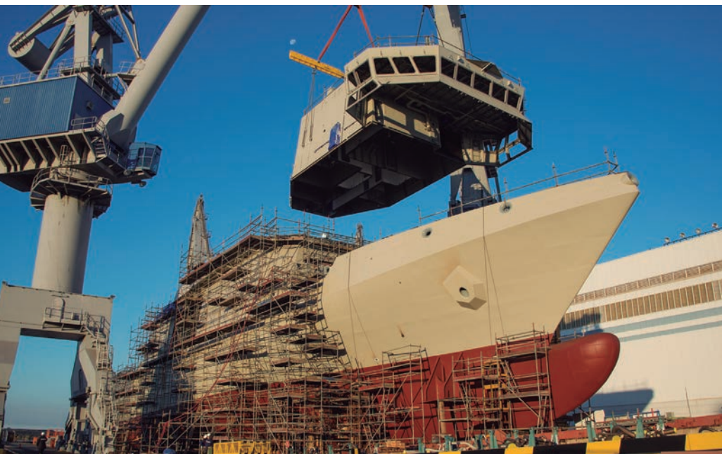
Montaje del último bloque de la estructura del quinto Buque de Acción Marítima de la Armada, el Audaz , que será botado en primavera.
