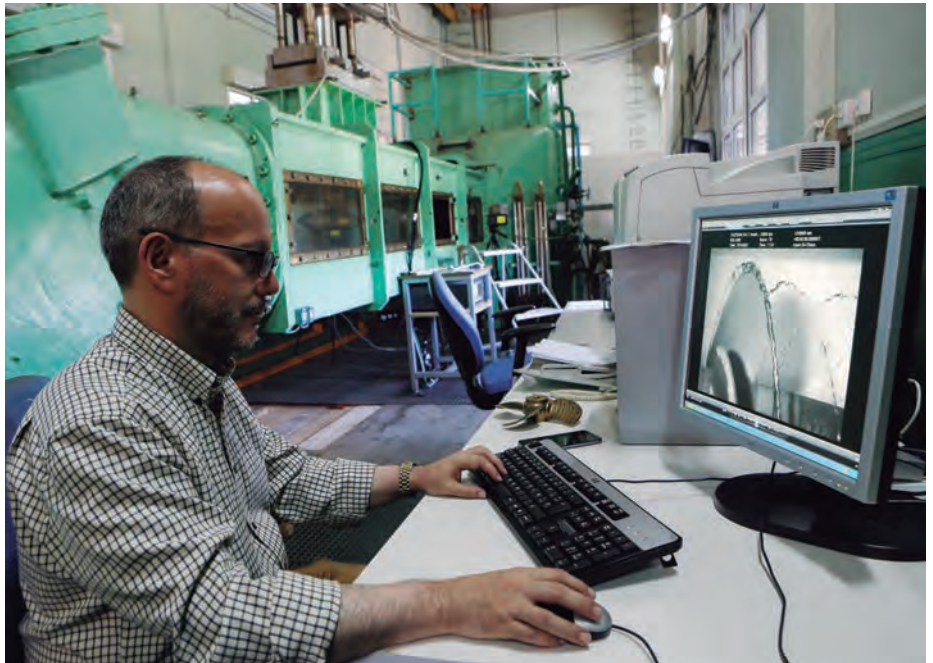
Desde el puesto de control del Túnel de Cavitación, un técnico comprueba los parámetros de un experimento con el modelo de una hélice.
