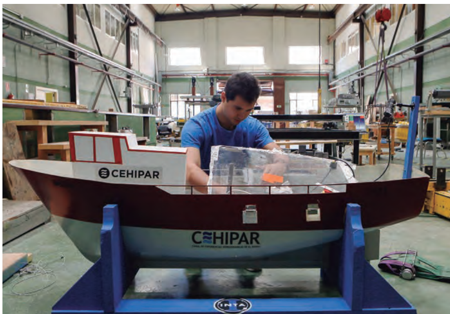
En los talleres del centro se construyen los modelos a escala de las embarcaciones que luego se introducen en los canales para realizar los experimentos.
