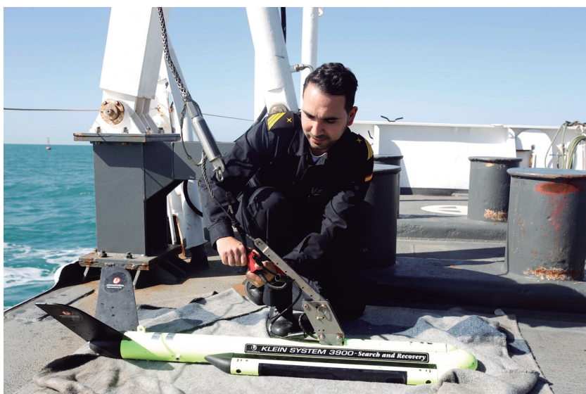
Preparación del sonar de barrido lateral (SBL) antes de su inmersión. En la página de la derecha, el buque hidrográfico Tofiño delimita los pilares del nuevo puente de la Constitución de 1812 sobre la Bahía de Cádiz.
