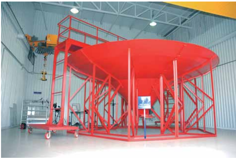
El laboratorio de simulación de impactos es un enorme embudo con un lecho de arena en su interior que permite comprobar la capacidad de destrucción de un meteorito.
