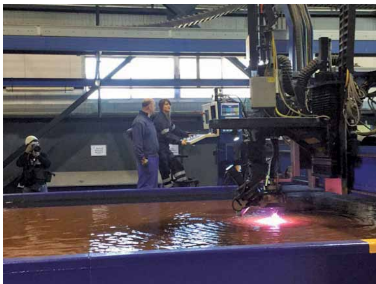
Trabajos de corte de chapa para los dos nuevos buques. A la derecha, el Meteroro , primer BAM construido en San Fernando.
