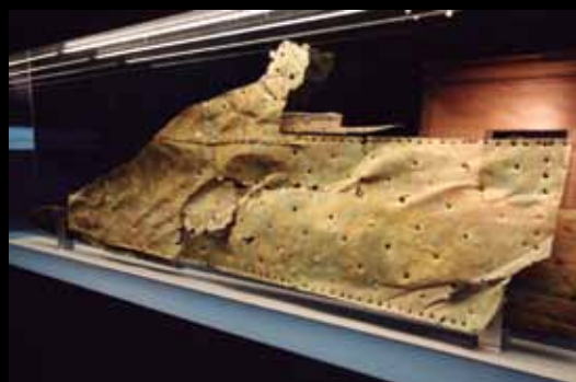
Forro de cobre del pecio de una fragata de 1791, que da idea del «blindaje» usado.
