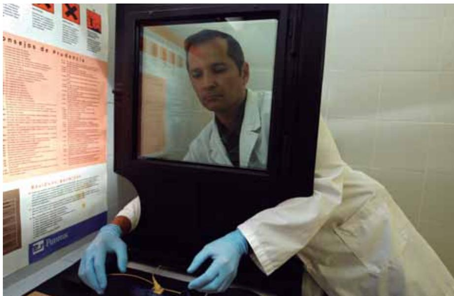
Pantalla protectora utilizada en el laboratorio químico como medida de seguridad.
